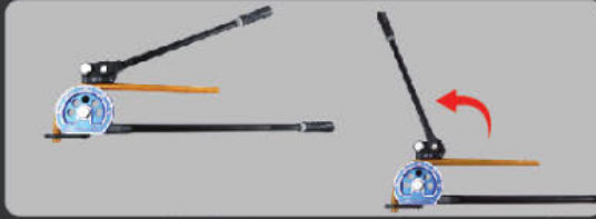
2 ยกตัวขึ้นเพื่อช่วยออกแรงในการดัดได้ง่ายขึ้น
