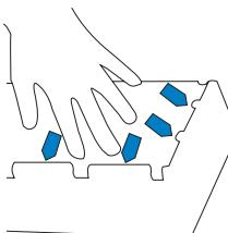
5.请轻压活性炭滤棉确保滤网卡在滤网盒卡槽的内部
