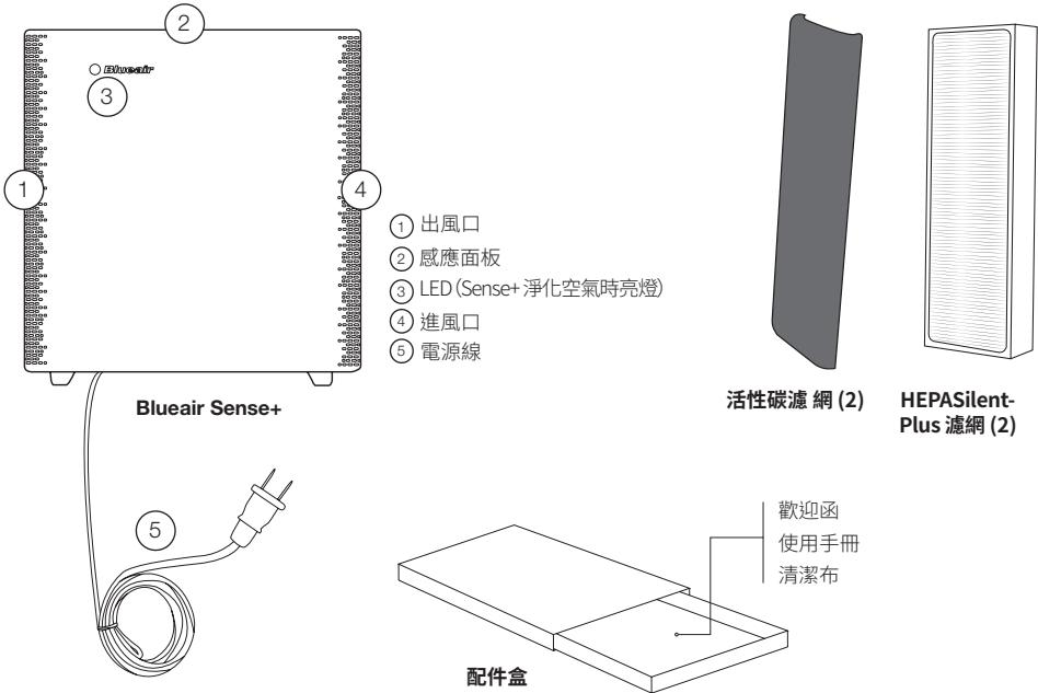
Sense+ 配有 Blueair 的專利裝置 HEPA Silent Plus，這是目前世界上最先進的無聲過濾系統。它革命性地組合了物理過濾和靜電過濾方法。空氣被吸入清淨機時，空氣中較大的顆粒物和氣態污染物在第一層過濾匣即被捕獲。接下來，空氣會通過一個離子室，在此未被物理過濾捕獲的顆粒物會帶上負離子，然後在第二層過濾匣中被帶有相反電極的離子纖維吸附捕獲。隨後，室內流通的即是真正純淨無污染的空氣。
