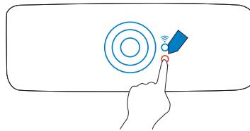
7.插上电源，将机器扶正放置，轻按控制面板上红色滤网提示灯。大约3-5秒后，红灯消失现在您的Blueair又可以给您带来洁净健康的空气了！
