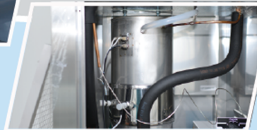
ตัวบรรจุน้ำร้อน เชื่อมด้วยท่อสแตนเลส ผ่านการตรวจสอบโรสารตะกั่ว โดยกรมวิทยาศาสตร์บริการ ระบบทาวเดินของกระป๋องน้ำเป็นสายยาวซิลิโคน วัสดุไม่เป็นอันตราย ใช้กับน้ำและอาหาร Food Grade
